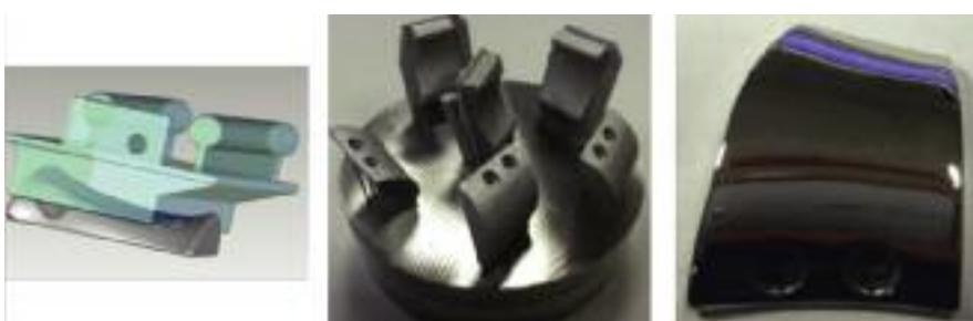
Figura 2. TAR CAD *models* (sinistra) sono importate in un software di 3DP; i relativi parametri di posizionamento sono settati opportunamente per ottimizzare il processo di SLM; dopo la stampa, la piattaforma con le componenti (centrale) viene controllata, e i relativi pezzi protesici trattati con le tecniche tradizionali di rifiniture *polishing* (destra).
