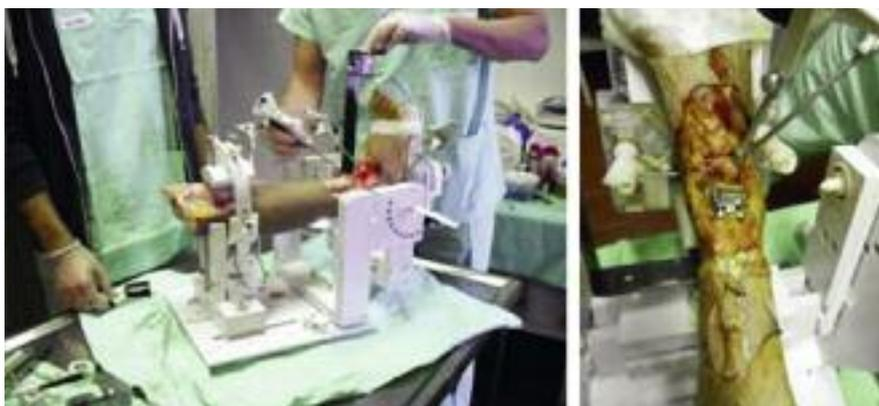
Figura 3. *Set-up* sperimentale: il preparato anatomico è montato sulla *rig* di test (sinistra); dettaglio dell'articolazione protesizzata (destra) che mostra anche il SNS coi suoi tracciatori e il puntatore.
