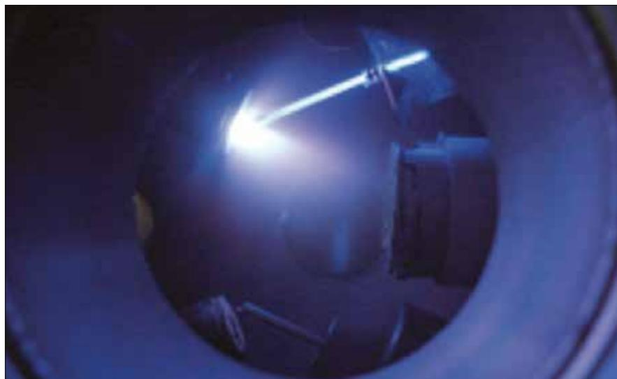
Fig. 2 Deposizione di rivestimenti di HA sostituita con tecnica *plasma-assisted*.
